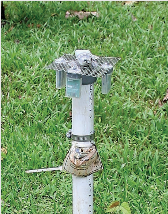
Fig. 5: Setup of the radiation sensors, one positioned horizontally (top) and four vertically in the main directions (Photo: R. STEINACKER). – Abb. 5: Aufstellung der Strahlungssensoren, einen horizontal (oben) und vier vertikal, die in die Haupthimmelsrichtungen zeigen (Foto: R. STEINACKER).
