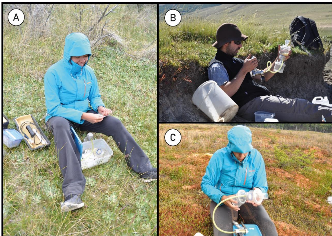
Figura 3-4. Filtración de las muestras de agua colectadas en las charcas, para la posterior determinación de clorofila a en el laboratorio. A) Almacenamiento del filtro. B) Detalle de la bomba manual de filtración. C) Dispositivo de filtrado de polcarbonato de 500 ml.
