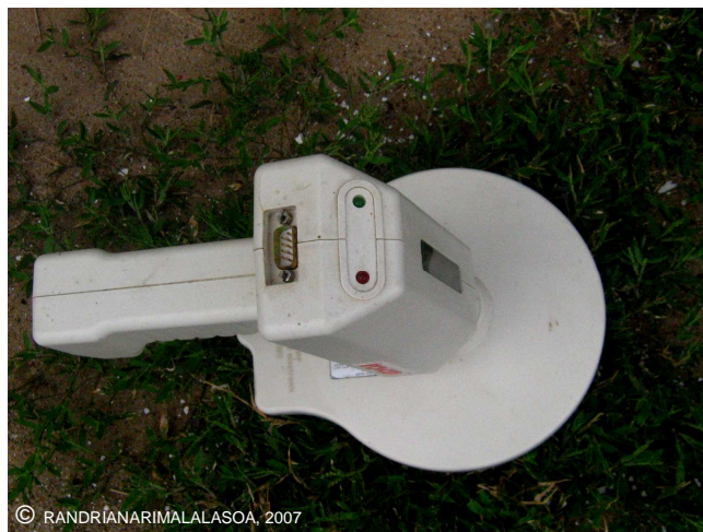
Photo 12: Appareil détecteur de la capsule magnétique (trovan)
