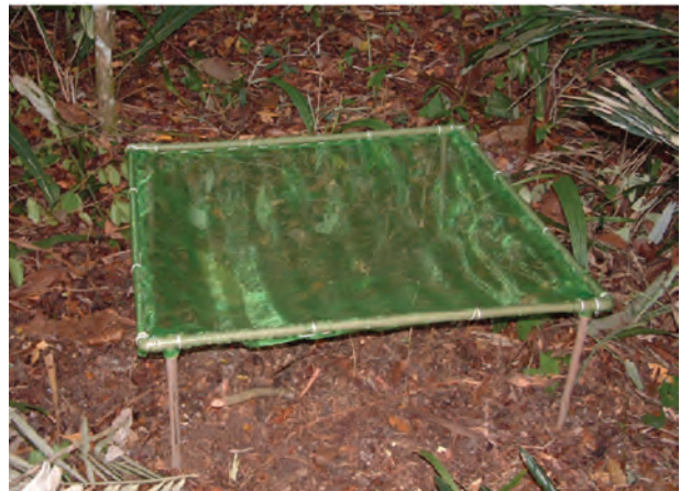
Figura 3: Coletor de sementes (1 m 2 ) utilizado na Reserva Natural Vale, estado do Espírito Santo, sudeste do Brasil, para amostragem da chuva de sementes. Foto: Isaac P. Lima.
