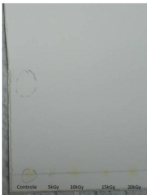
FIGURA 16: CCD dos extratos de Zingiber officinale com fase móvel acetato de etila/ ácido fórmico/ água (90:5:5) e NP-PEG como revelador
