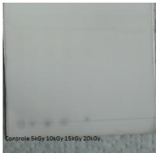
FIGURA 20: CCD dos extratos de Curcuma zedoaria com fase móvel hexano/ ácido de etila (60:40) e vanilina sulfúrica como revelador
