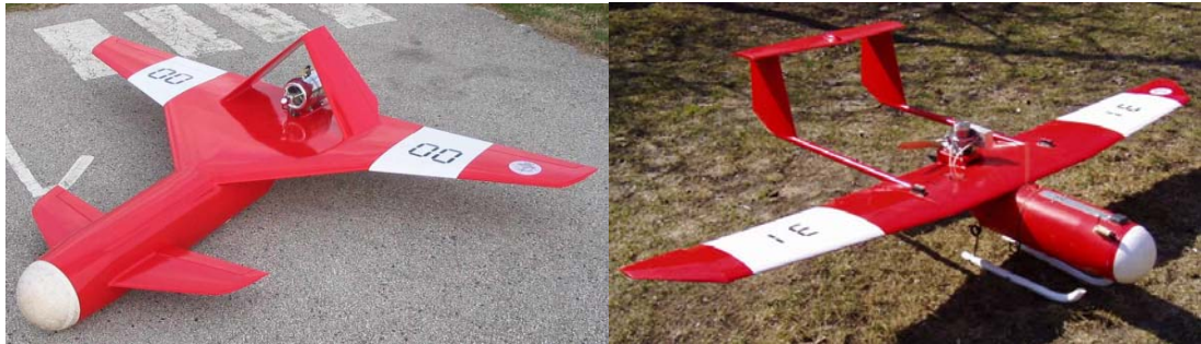
2. kép: British Aerospace 18cm átmérőjű Luneberg lencséjének alkalmazása az Aero-Target Bt. gyártmányú Ugkly Duckling és a Meteor-3R típusú TUAV-n
